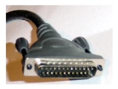
DB-25 Stecker zur Verbindung mit paralleler Schnittstelle des PCs (DB-25 Buchse)
