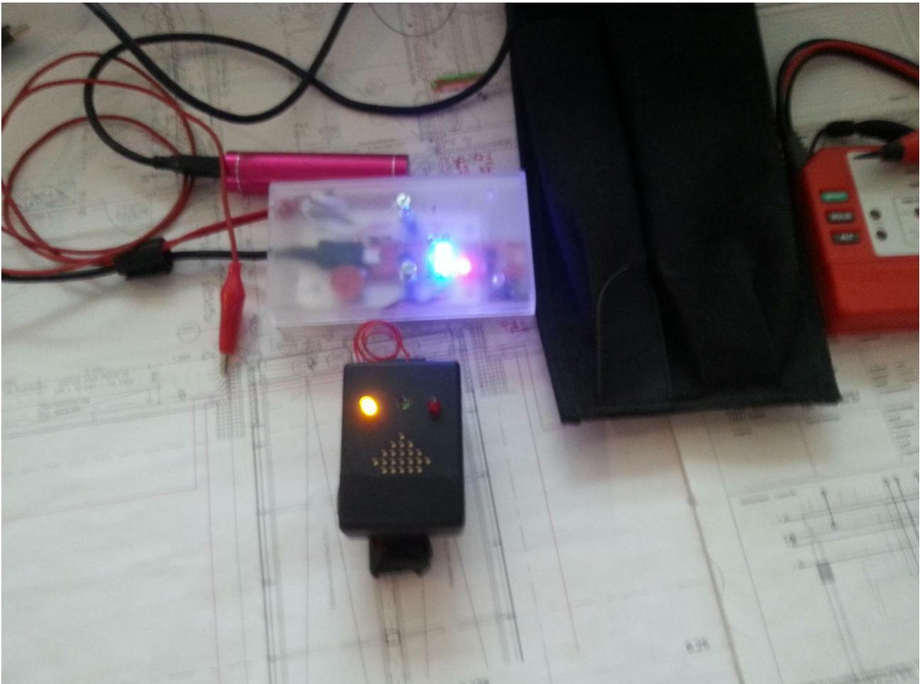
Hier im Bild zeigen unsere zwei, das sie an einer (pinkfarbenen) Powerbank arbeiten. Die Schrauben im Gehäuse des Senders sind nur meine einfache Lösung um die Tasterknöpfe zu verlängern.
