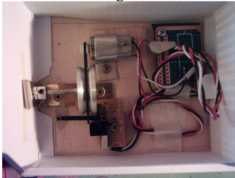
Abbildung 6 Antrieb Wasserrad
