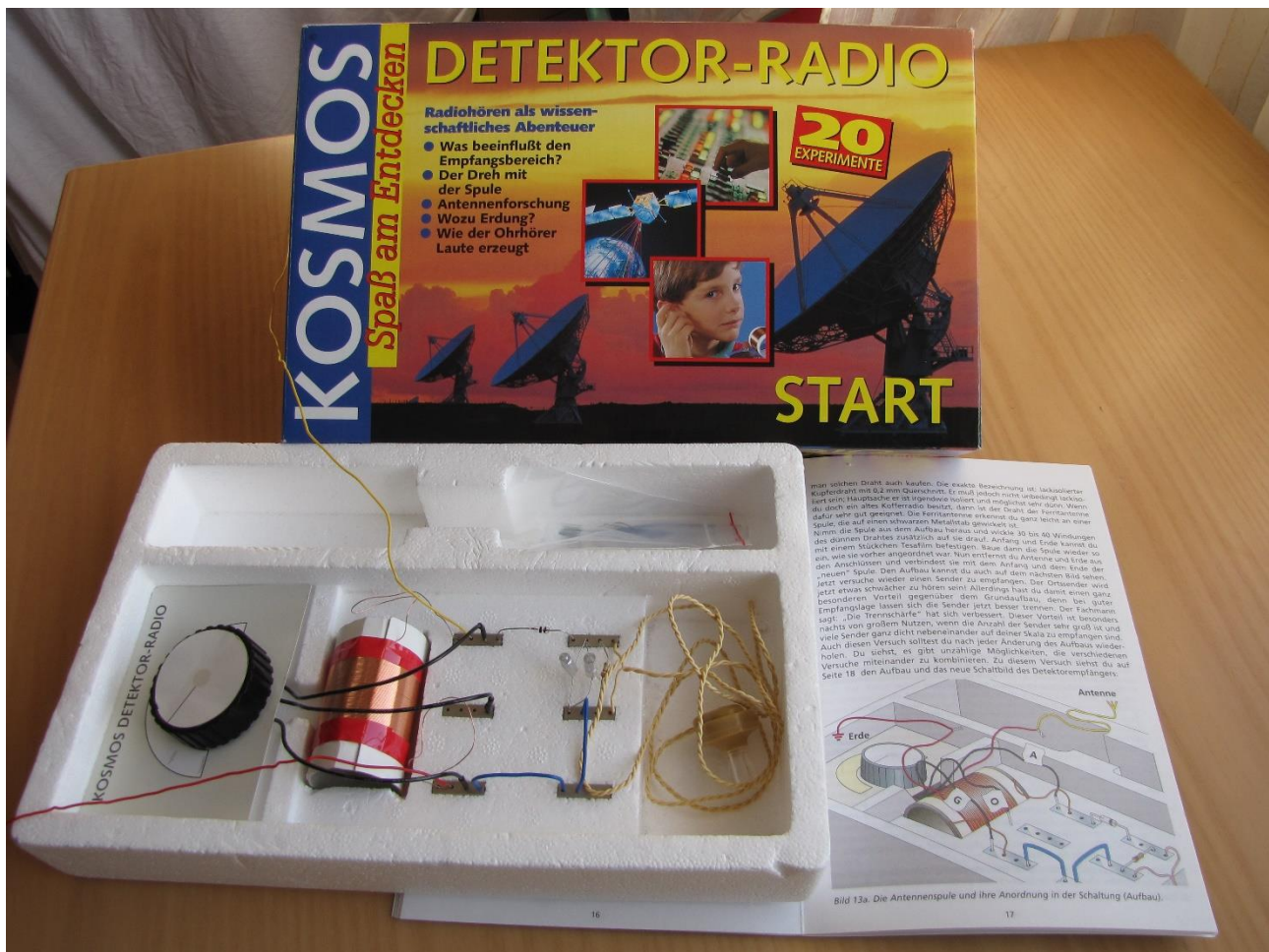
Abb. 4: Kosmos-Experimentierkasten „Detektor-Radio“ mit Drehkondensator, Zylinderspule, Germaniumdiode und Ohrhörer (1996)
