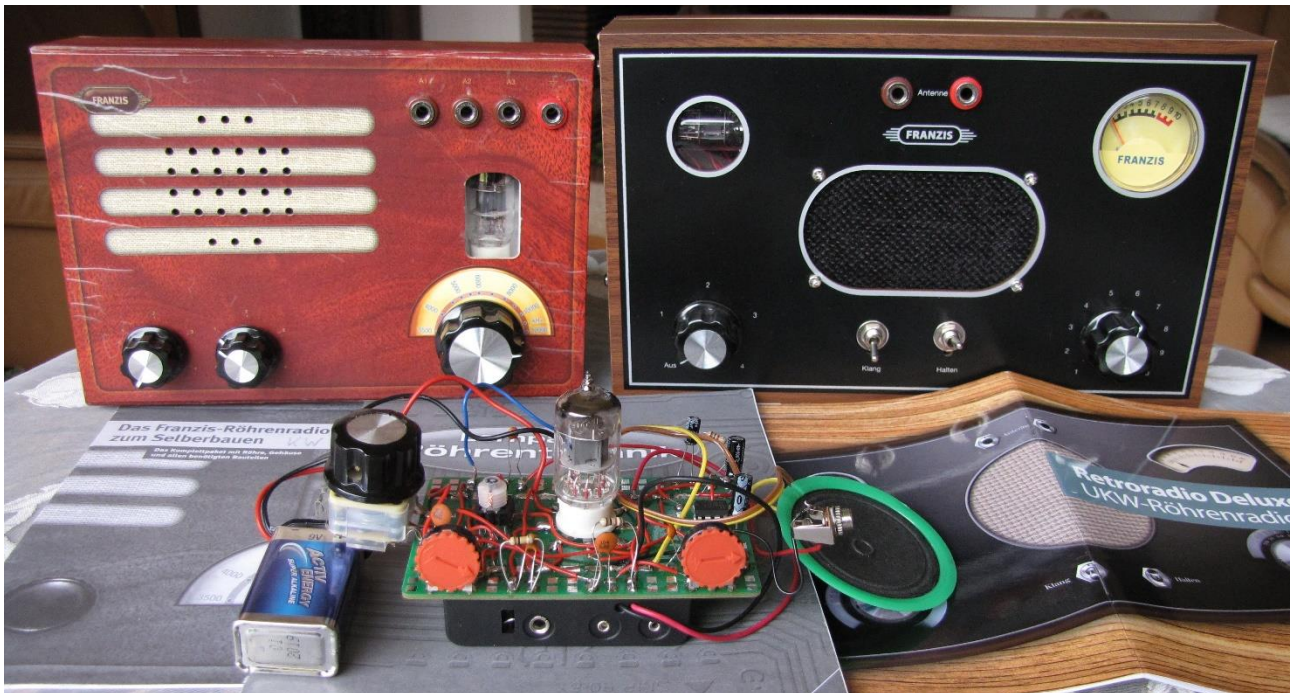
Abb. 7: Franzis-Baukästen „Röhrenradio“, „Retroradio Deluxe“ und „Röhrentechnik“ von B. Kainka mit der chinesischen Röhre 6J1 (2009, 2011)
