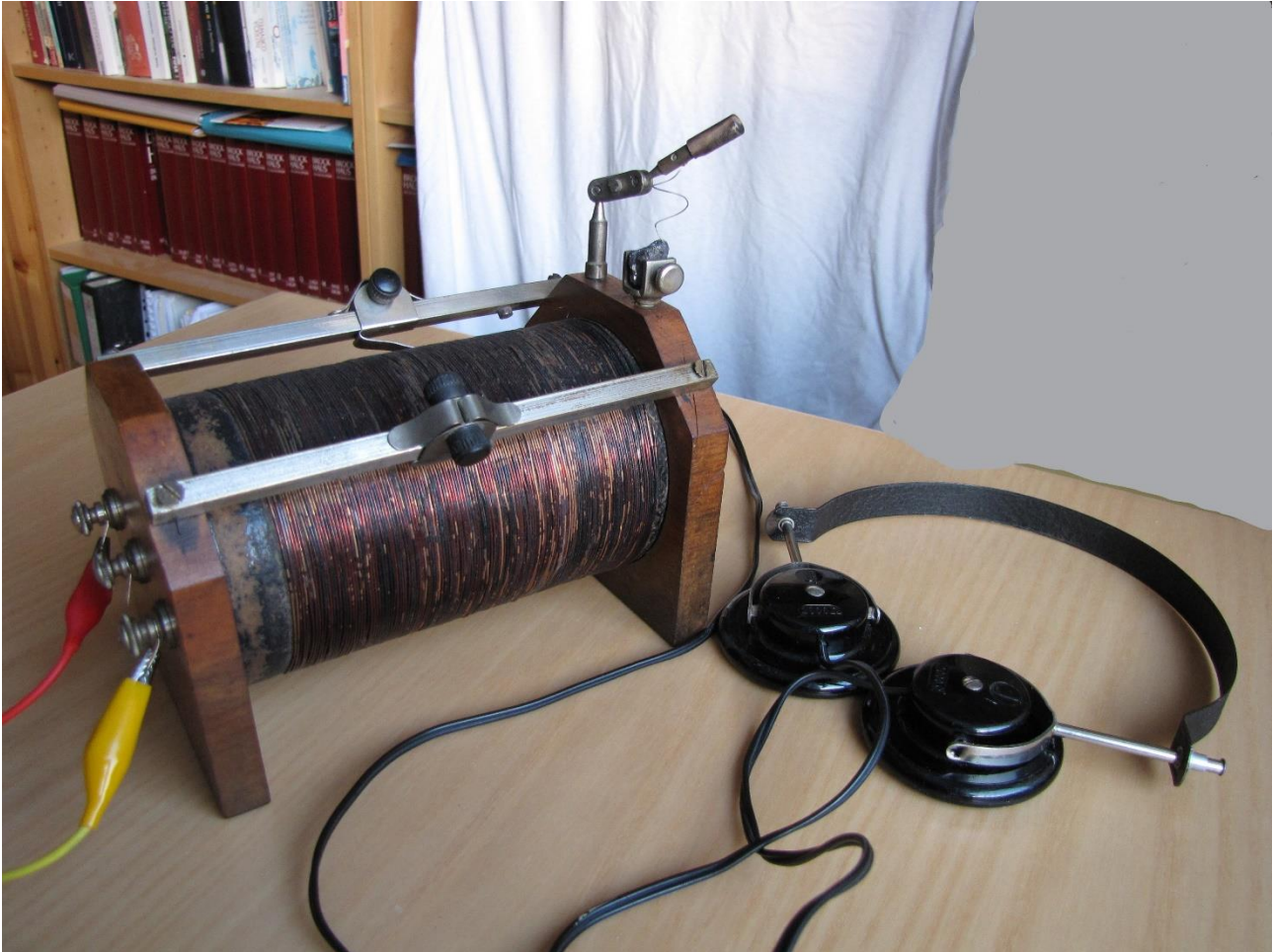
Abb. 1: Französischer Kristalldetektor mit Bleiglanzkristall und Schiebespule (1920er Jahre)
