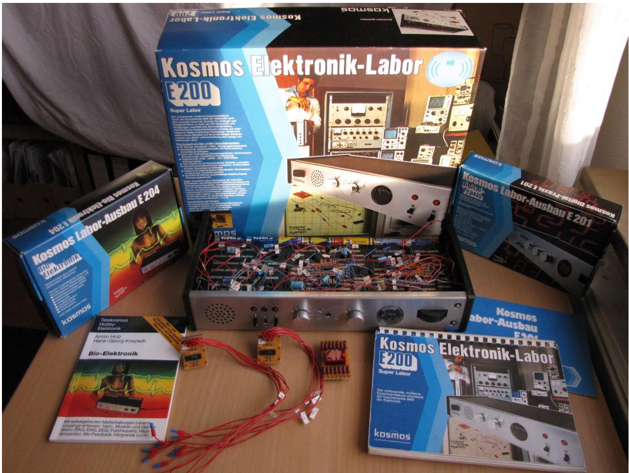
Abb. 16: Kosmos-Elektronik-Labor E200 (1979) mit Ergänzungskästen E201 „Digitalpraxis“ und E204 „Bio-Elektronik“ (1980)
