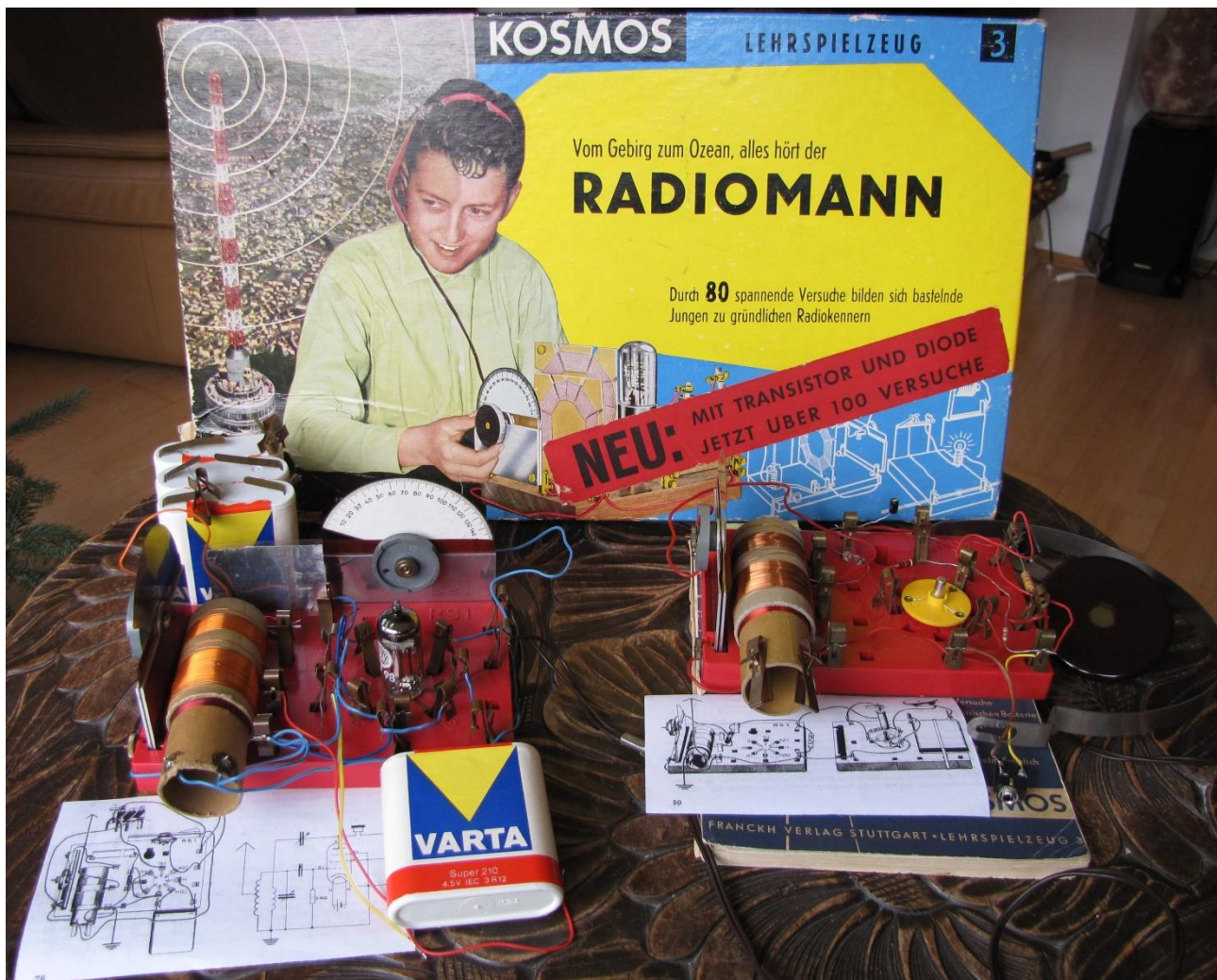
Abb. 10: Kosmos-Experimentierkasten „Radiomann“ von W. Fröhlich (1960). Aufbau von Röhrenaudion mit EF98 und Radio mit Germaniumdiode und Transistor OC71 (AC173)
