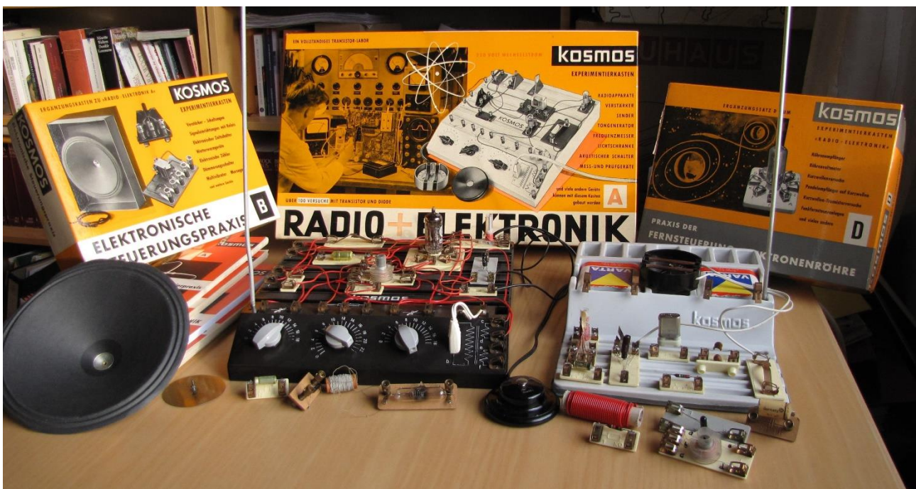
Abb. 5: Kosmos-Experimentierkästen „Radio + Elektronik A, B und D von Heinz Richter mit Transistoren und Röhre EF98 (1958 und 1963)
