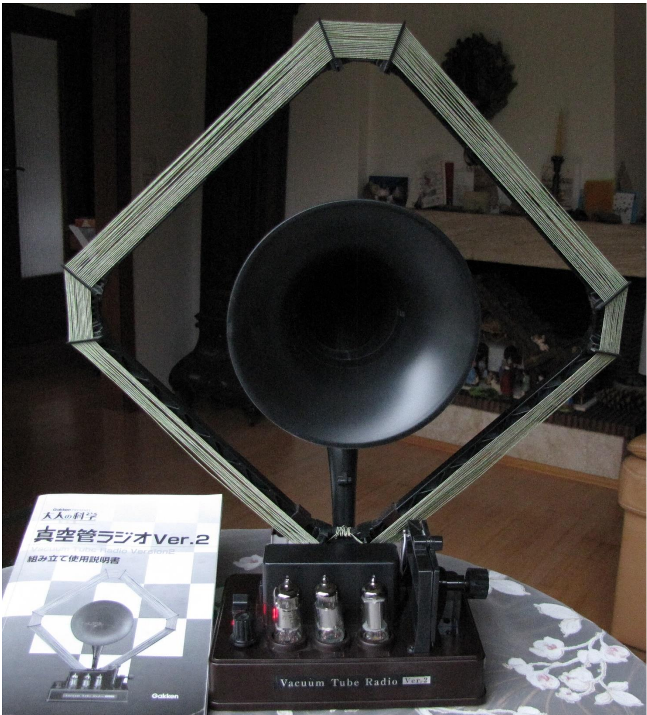
Abb. 9: Baukasten „Vacuum Tube Radio Ver. 2“ der japanischen Firma Gakken mit Rahmenantenne, Klappkondensator, Hornlautsprecher und den chinesischen Röhren 1K2, 1B2, 2P2
