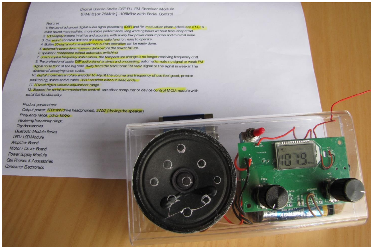
Abb. 21: DSP PLL FM-Receiver Modul aus China, eingebaut in eine transparente Box (2018)
