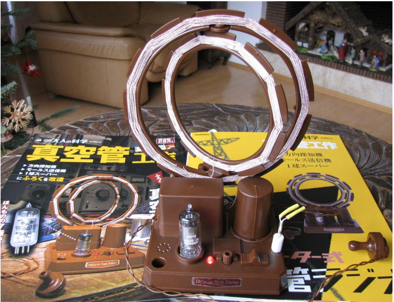
Abb. 8: Baukasten „Vacuum Tube Radio“ der japanischen Firma Gakken mit der chinesischen Röhre 1A2, Drehko- und Variometerabstimmung
