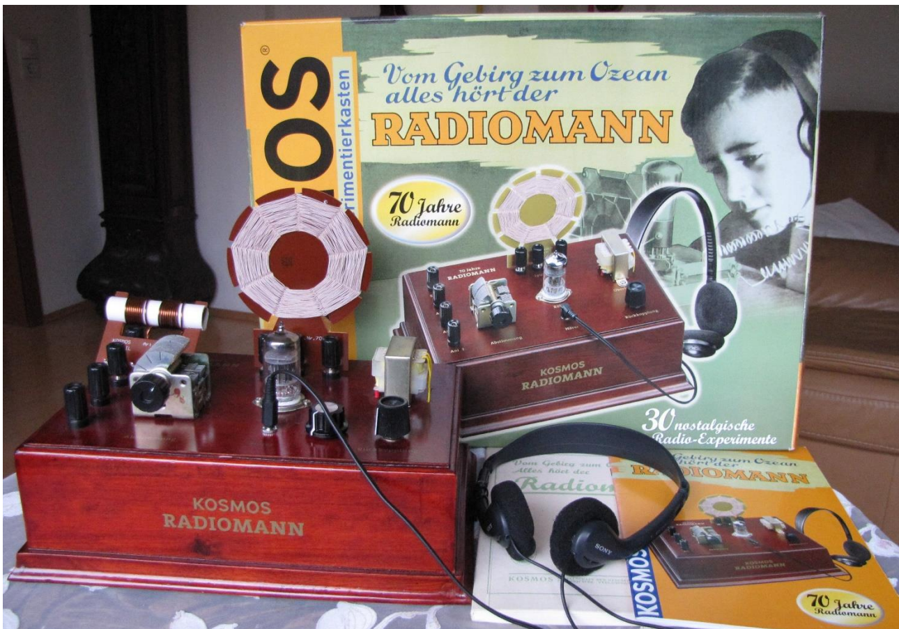
Abb. 6: Kosmos Jubiläumsausgabe „70 Jahre Radiomann“ mit der Doppeltriode ECC82, Korbodenspule, Luftdrehko und NF-Übertrager (2004). In das Gehäuse wurde nachträglich ein NF-Verstärker mit Lautsprecher eingebaut.
