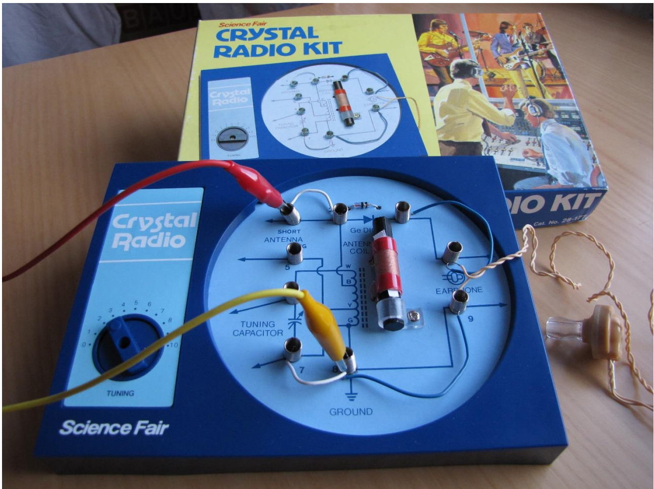
Abb. 3: Baukasten mit Germaniumdiode, Drehkondensator, Spule mit Ferritkern und Ohrhörer aus den USA (1980er Jahre)
