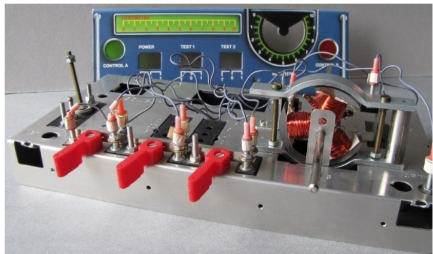
Abb. 2.52: Aufbau eines Gleichstrommotors mit Polumschalter auf dem Metallchassis
