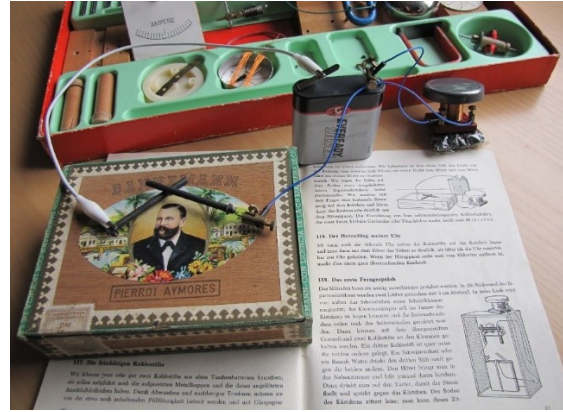
Abb. 2.47: Versuchsaufbau Die feinhörigen Kohlestifte
